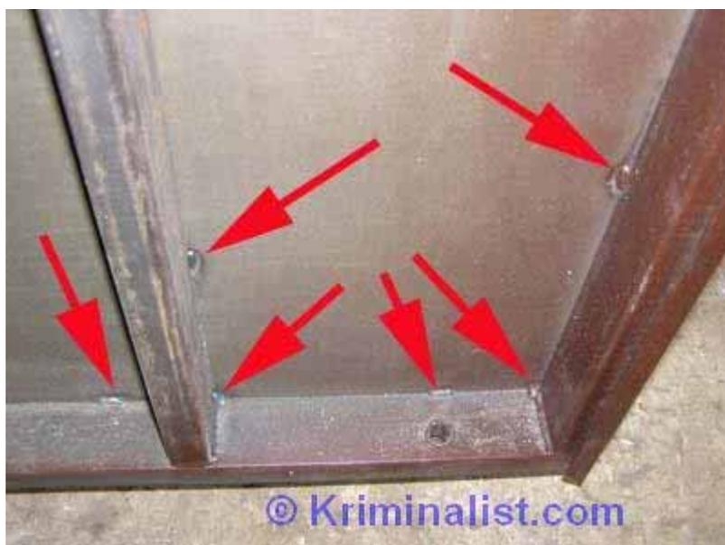
**Фото 17.** Вид мест сварки в нижней части двери. Качество сварки не соответствует требованиям ГОСТ.
