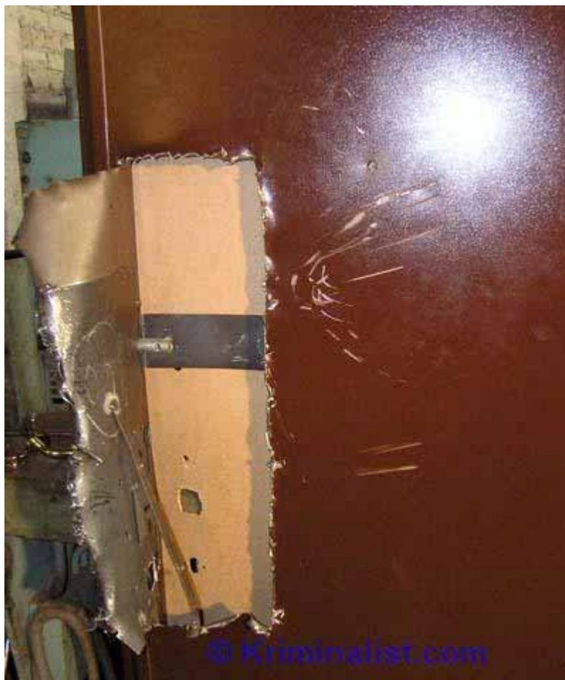
**Фото 49.** Одним ударом по замку два винта М6 были срезаны и замок вывалился. Проход открыт. Время полного открывания двери таким способом составило 14 минут.
