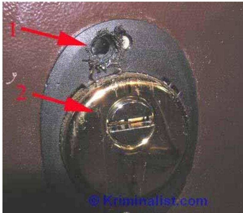
**Фото 35.** Отметка 1-отверстие в проекции стойки стопора пластины, закрывающей скважину для ключа сувальдного механизма. Отметка 2-броненакладка, защищающая цилиндрический механизм.
