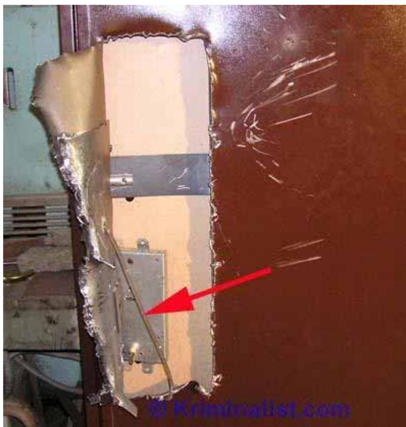
**Фото 47.** При последующем отгибании листа, крепление замка (два винта М6) сломалось. Оторвалась и пластина, на которой крепился замок из-за некачественной сварки (показана стрелкой).
