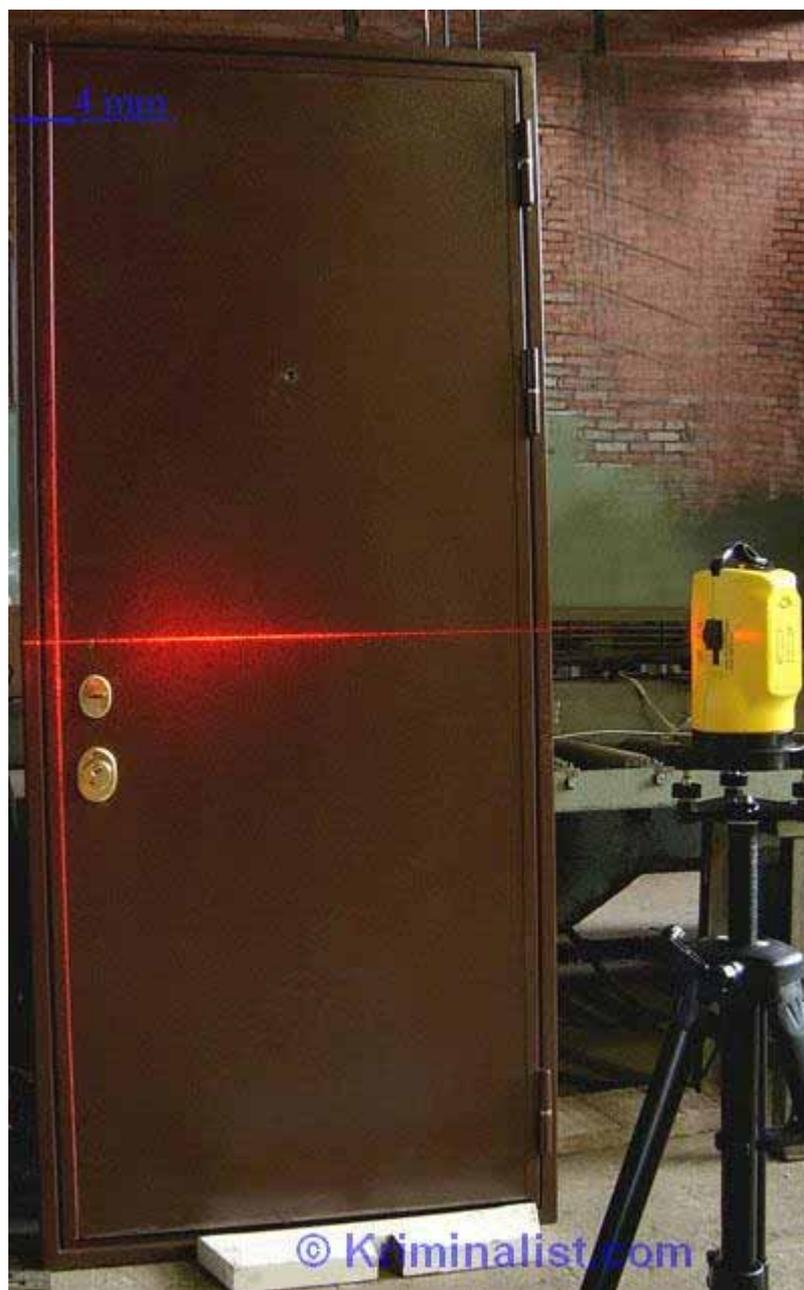
**Фото 9.** Вид двери установленной строго по уровню.
