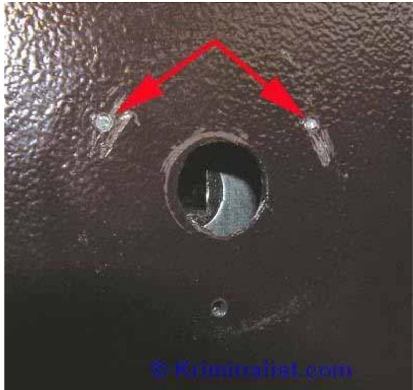
**Фото 8.** Вид места крепления поворотной ручки с наружной стороны двери. Красными стрелками показаны срезанные саморезы.
