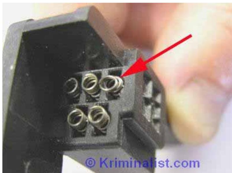
**Фото 30.** Вид механизма сувальдных пружин. Красной стрелкой указана погнутая пружина, которая не давала двигаться одной крайней сувальде.
