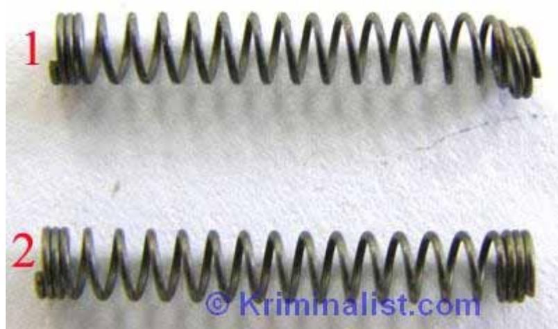
**Фото 31.** Вид пружин сувальд. Цифрой 1 отмечена гнутая пружина - причина неисправности замка. Цифрой 2 отмечена нормальная пружина (для наглядности).
