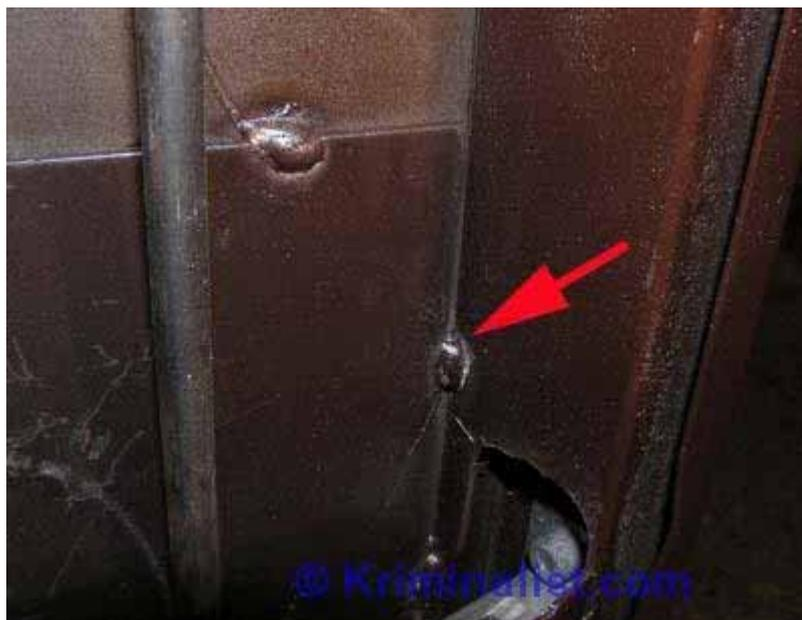
**Фото 50.** Стрелкой показано, что место сварки отвалилось в результате воздействия на дверь - отжим.
