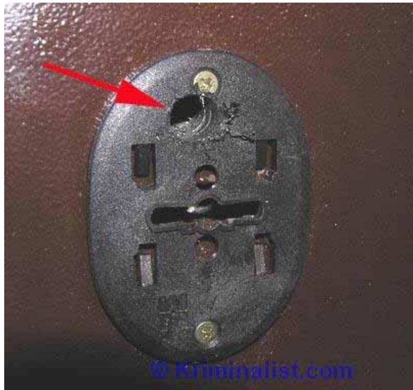
**Фото 36.** Вид отверстия в проекции стойки хвостовика засова.
