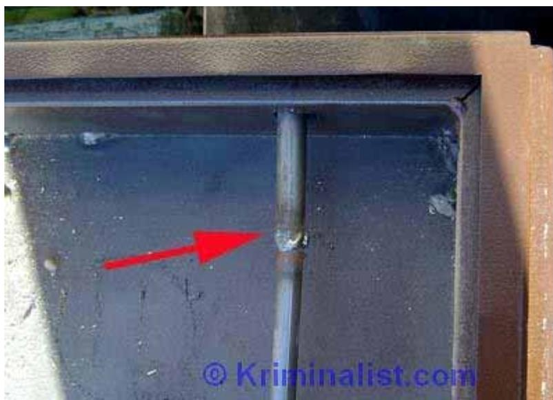
**Фото 16.** Вид верхней тяги. Красной стрелкой показано искривление верхней тяги и ржавчина вокруг места сварки, хотя с момента изготовления двери прошло не так много времени.
