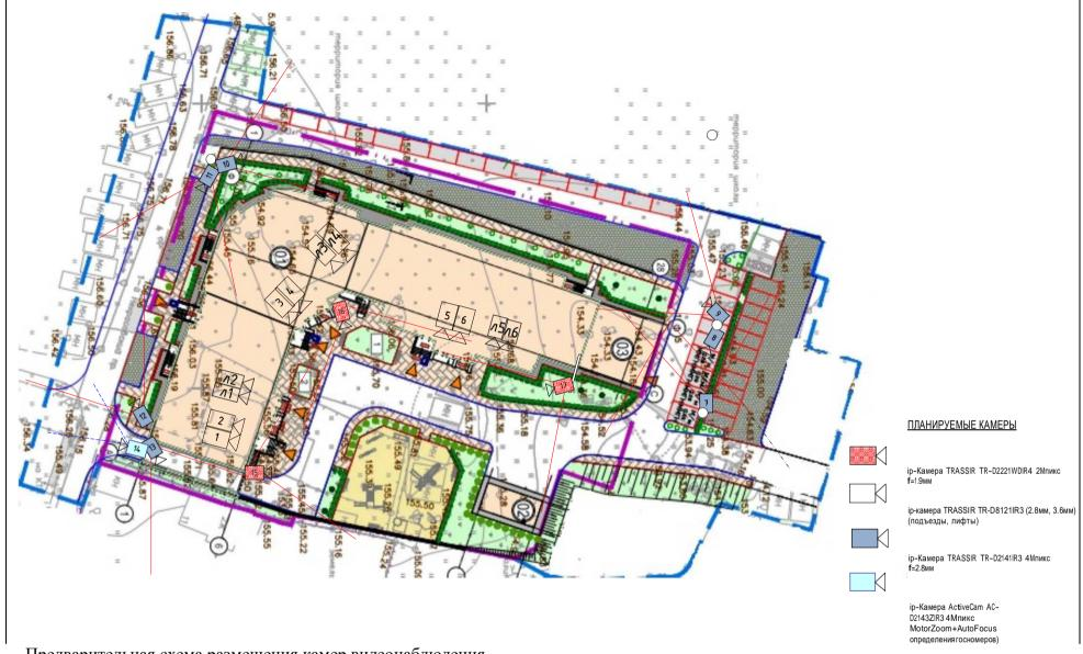
Предварительная схема размещения камер видеонаблюдения
